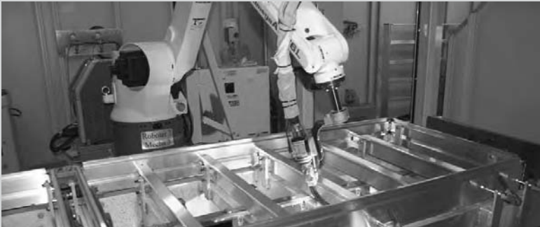
Moderner Schweißroboter: sorgt für rationelle Serienfertigung im Hause Mack Alu-Systeme
